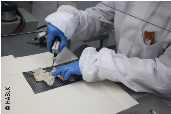
Reinigen / Abstrahlen des Fragments mit Arbocel
